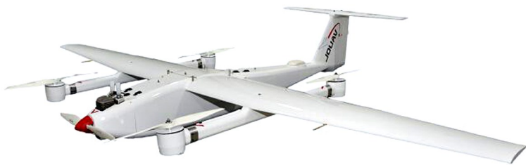
图 1-17 垂直起降固定翼无人机
